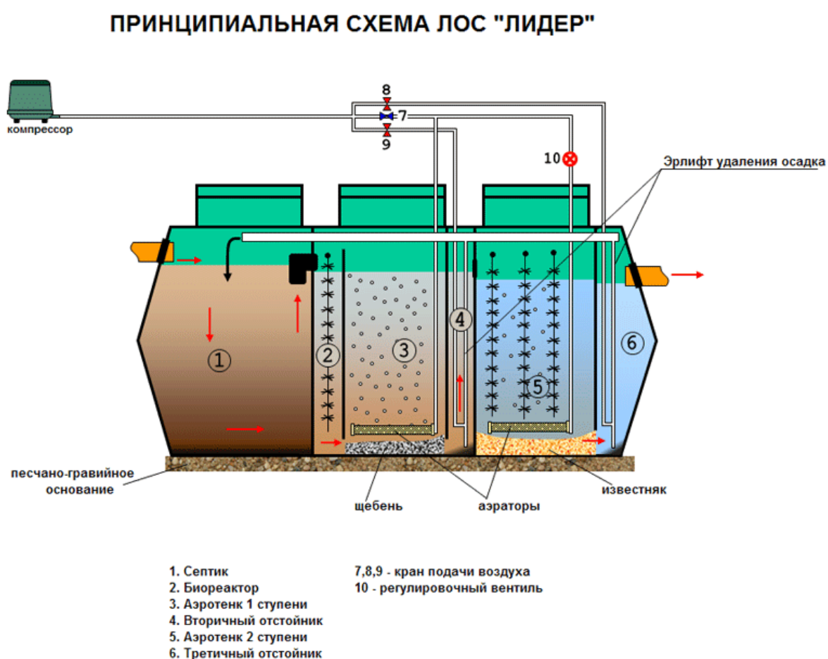
Рисунок 10. Принципиальная схема септика Лидер.
